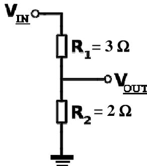
Para esse circuito, a relação de transferência ( $V_{OUT}/V_{IN}$ ) vale
